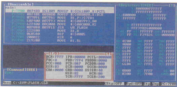
Bild 4. Außer dem Source-Level-Debug gibt die Software auch Zugriff auf Register- und I/O-Bereiche.
